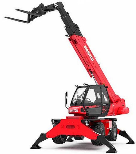
Geschwenkt auf Stützen mit Gabelzinken
